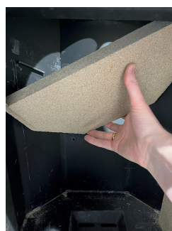
Øvre plate løftes opp, orienter platen så den kan fjernes.
