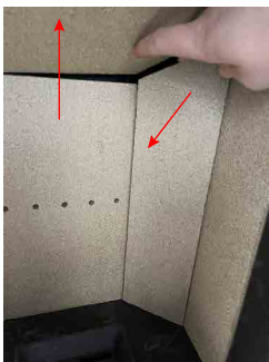
Løft opp øvre plate, fjern så bakre sideplate høyre.
