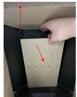
Løft opp øvre plate, fjern så bakplate.
