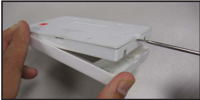
Figur 1 Demontering av veggbryteren
